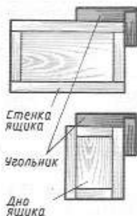
Рисунок 92. Проверка ящика угольником.
