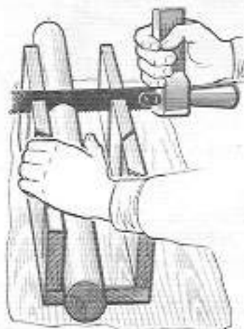
Рисунок 31. Пиление в стусле деталей цилиндрической формы.
