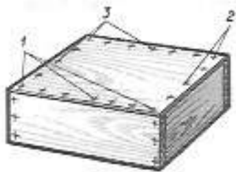
Рисунок 91. Крепление дна ящика: 1 — 3 — последовательность работы.
