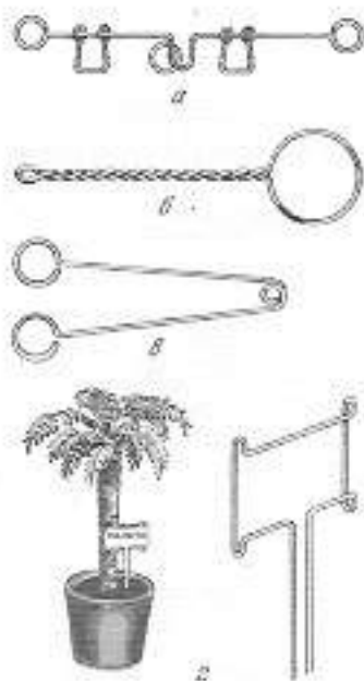
Рисунок 47. Изделия из проволоки: а — головоломка; б — кольцо для сачка; в — щипчики для сухого горючего; г — основание для этикетки.
