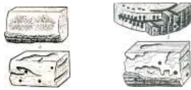
Повреждение древесины (червоточины): а — поверхностная; б — неглубокая; в — глубокая; г — сквозная.
